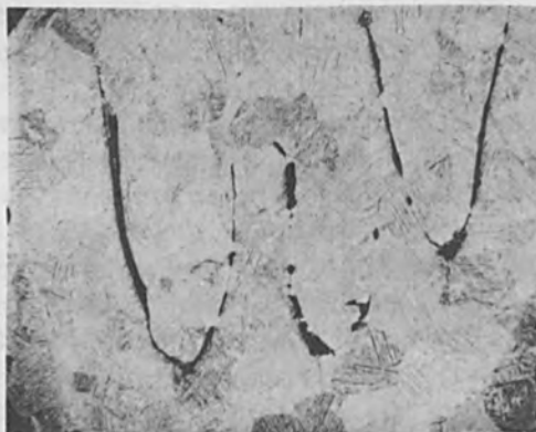
FIG. 8.—Cold shut, Ti 6 Al 4V. (Courtesy: J. Gerken, TRW.)
