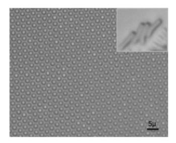
Fig. 2. DIC micrograph of magnetic PDMS pillars
